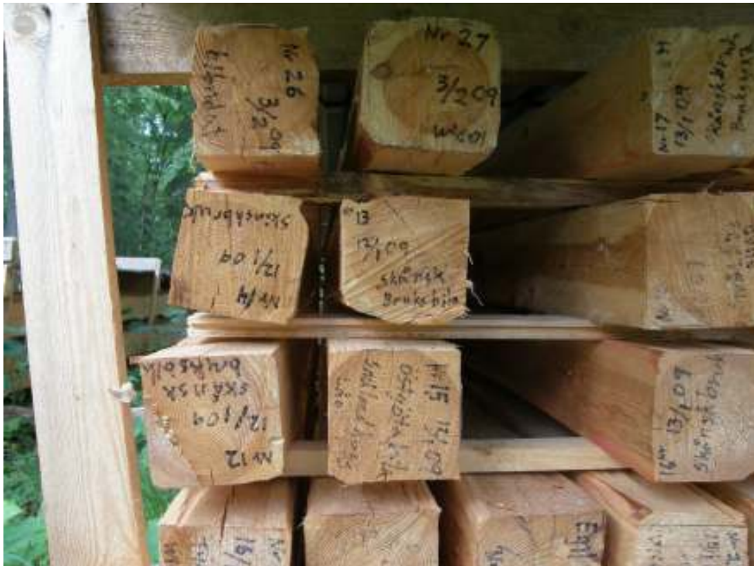
Bilat ämne till sparrarna. Notera verktygs- och datumangivelser.
