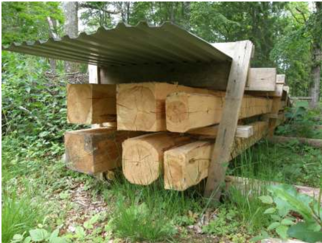
Bilat ämne till fotträ och bindbjälkar.
