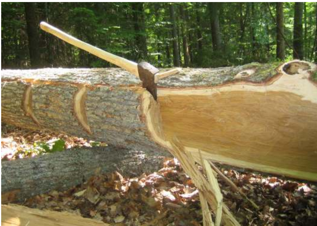
Utskulkning efter att stocken blivit skyrbuggen. Foto Olof Andersson.
