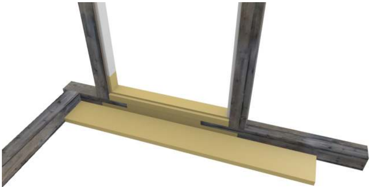
Fig. 2. Skalenlig omfattning av bytt och skarvat timmer på fotträ och tröskel mm i anslutning till ytterdörren. Bilden visar utsidan. Jublin Alfberg, 2011.
